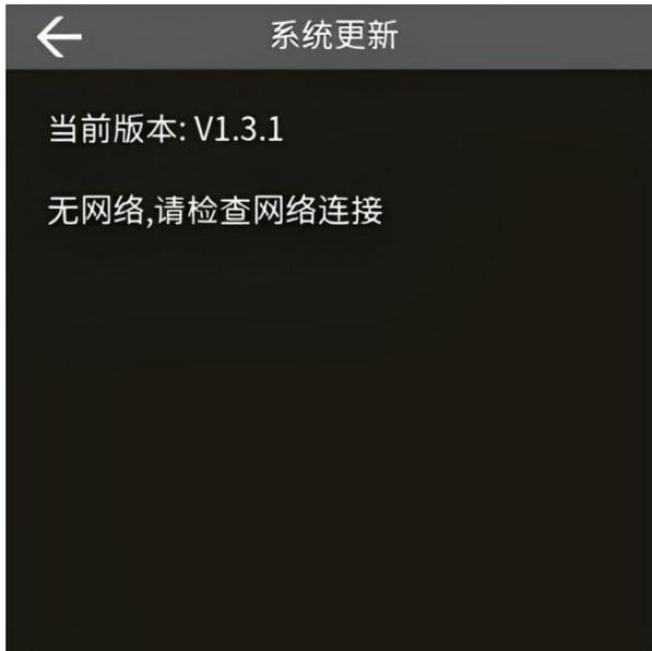
(2) 已连接 wifi，显示升级按钮，点击可以进行系统更新，更新完毕显示最新版本字样
