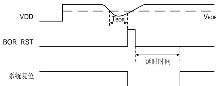
注:  $T_{BOR}$  需大于 200ns, 否则电压跌落时可能不产生欠压复位信号。
