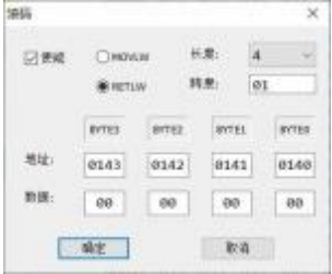
图 4.4-2 滚码配置对话框，配置“使能”、“MOV LW”、“RETLW”、长度、跨度、地址、数据
