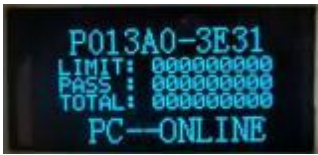
图 3.2-5 BL-PM18-V5 显示屏确认芯片型号及芯片特征码
