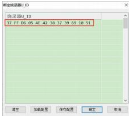
图 4.6-5 “绑定烧录器 U_ID” 设置对话框，设置后烧录文件只允许下载至指定烧录器（设置前连接 BL-PM18-V5，进入设置对话框后会自动读取并填写好 U_ID）
