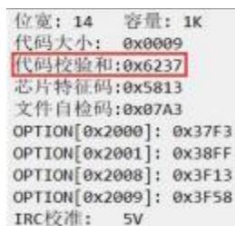
图 4.2-3 信息提示窗口确认“代码校验和”是否与 BL-IDE 软件编译输出窗口的 CODE_CRC 是否一致
