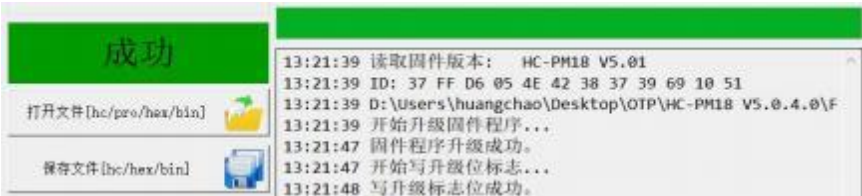
图 5-3 固件更新成功，请耐心等待 BL-PM18-V5 硬件复位，蜂鸣器“滴”一声后烧录器固件更新成功
